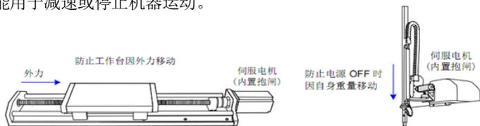
图 5-8 电磁制动器应用示意图
